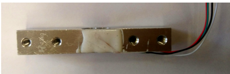
Slika 1: Merne trake koje su postavljene na senzor mase koji može da meri do 10 kg. Za merenje se koristi HX711AD modul (uputstvo je dostupno na https://www.digikey.com/htmldatasheets/production/1836471/0/0/1/hx711.html ). Fotografisano na Elektrotehničkom fakultetu Univerziteta u Beogradu.
